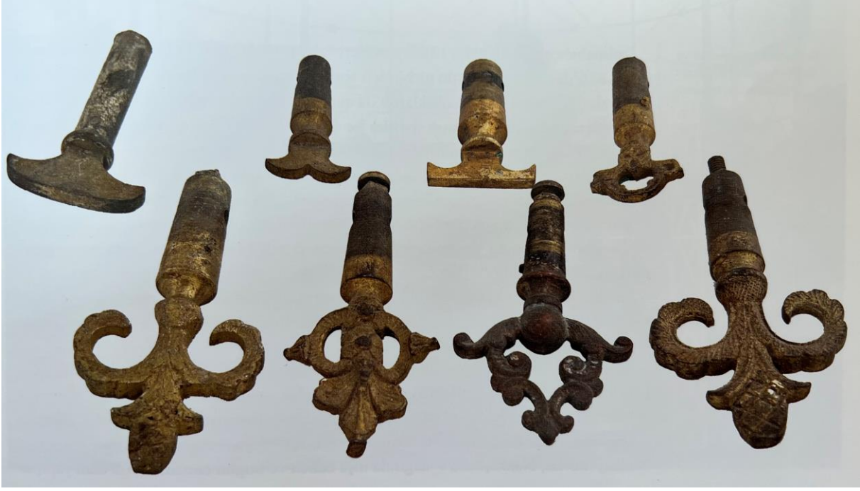
Şekil 3. Havagazlı lambalarda kullanılan ancak elektrikli sisteme geçilince işlevini yitiren havagazı muslukları [4]
