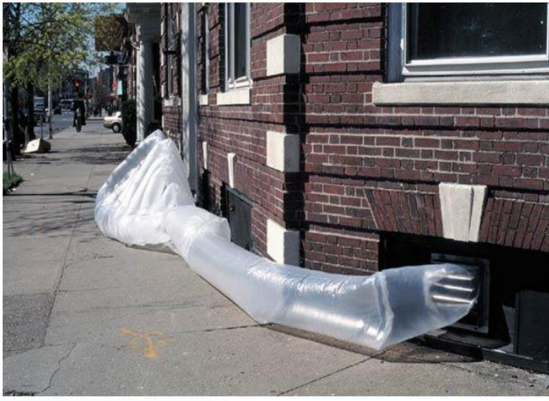
Şekil 3. Var olan bir yapının havalandırma sisteminden faydalanarak parazitik yerleşim sağlayan Pynomatik (şişme) yapı örneği [3].
